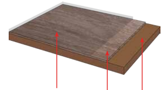
Transparente ACRYLAT-Schutzschicht Druckfarbe eingefärbte, wärmereduzierende Kunststoff-Basisfolie
